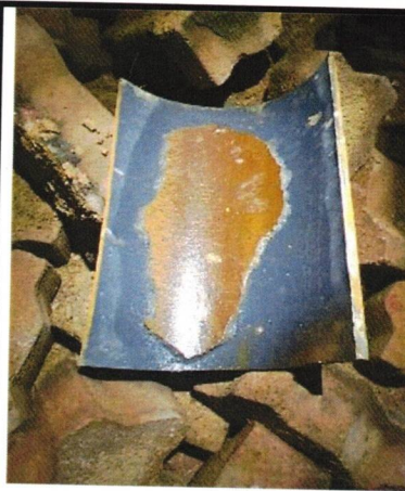
←2019 年 9 月翠麗迴旋處掘出消防喉內部生銹狀況
